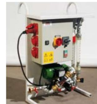
Schaltschrank mit Wasserarmatur, Durchflussmesser und Wasserpumpe auf einhängbarem Gestell
